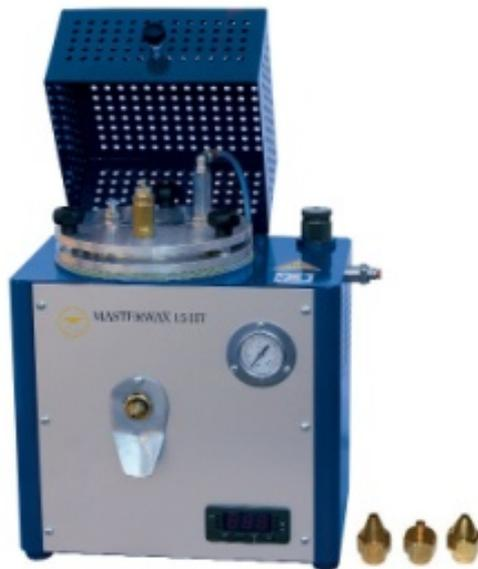
Particolare versione dell'iniettore da kg 1,5 indicato per cere per scultura, in grado di fondere fino a 145°. Dotato di termostato digitale, è disponibile solamente con attacco per aria compressa, in quanto la cera per scultura necessita di una pressione di 2,5-3 bar per essere iniettata.
